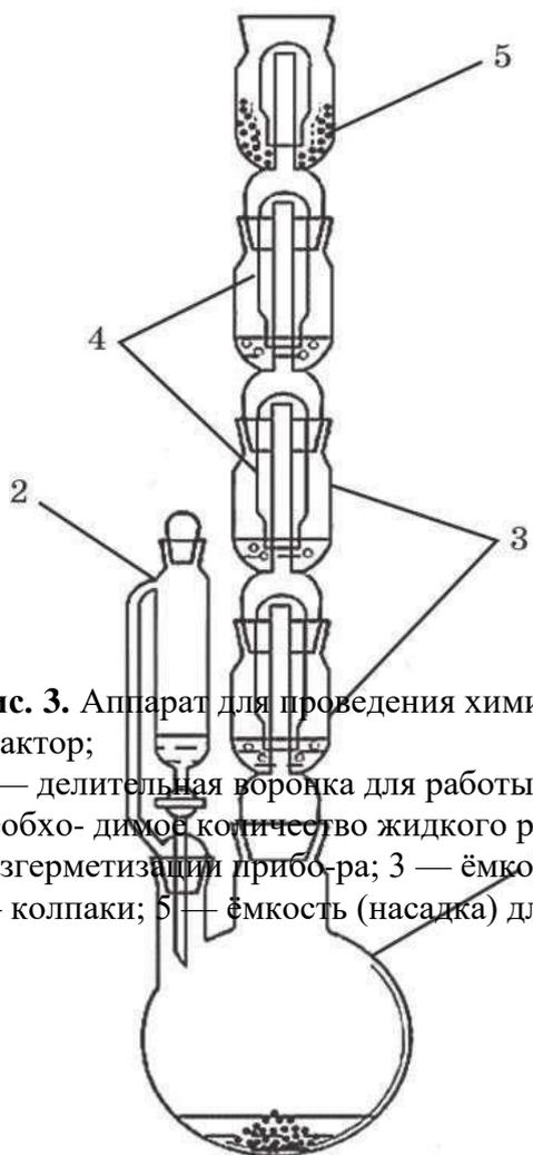
**Рис. 3.** Аппарат для проведения химических реакций (АПХР): 1 — двугорлая колба-реактор; 2 — делительная воронка для работы с жидким реагентом; 3 — ёмкости (насадки) для жидких реагентов (поглотителей); 4 — колпаки; 5 — ёмкость (насадка) для сыпучих реагентов
