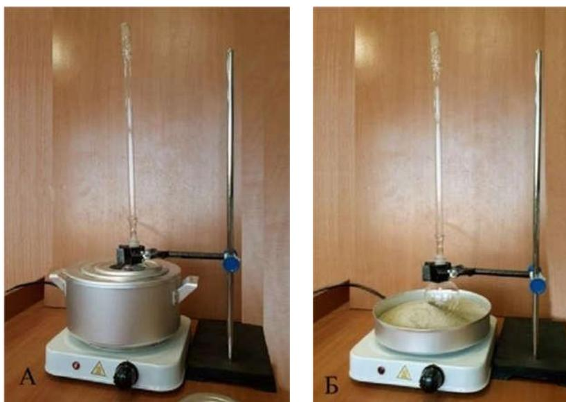
**Рис. 6.** Баня комбинированная лабораторная. А — водяная баня. Б —
