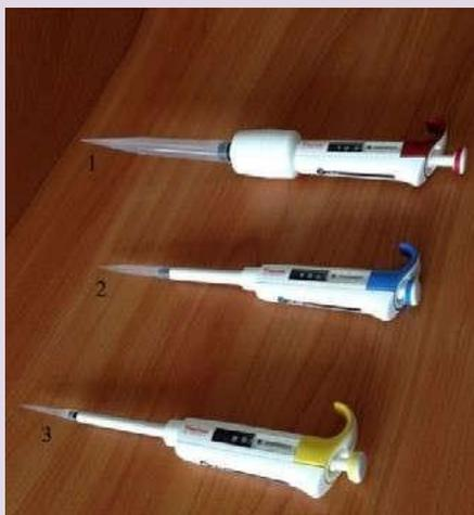
**Рис. 5.** Пипетки дозаторы одноканальные переменного объёма: 1 — 110 мл; 2 — 100—1000 мкл; 3 —
