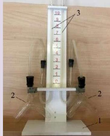
соединяются с сосудами Ландольта с помощью пластиковой трубки с пробками (рис. 5). Между манометрическими трубками на панели нанесена шкала для наблюдения уровня жидкости в трубках. Окрашенной жидкостью может быть раствор любого красителя в воде.
