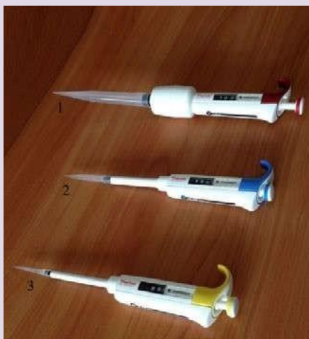
Рис. 5. Пипетки дозаторы одноканальные переменного объёма: 1 — 110 мл; 2 — 100—1000 мкл; 3 —
